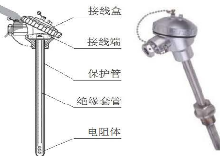
图2-5 热电阻结构图及外形图
